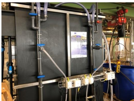
Tank innehållande membran för direkt membranfiltrering.
