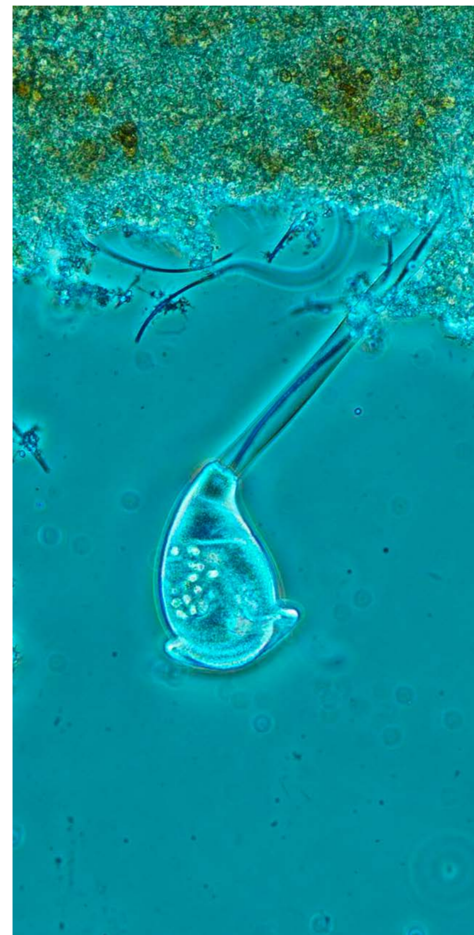
Mikroskoperingsbild på biofilm och mikrodjur (stjätkad ciliat) från en Z-400 bärare i en kommunal MBBR pilot, AnoxKaldnes (foto: Maria Piculell).
