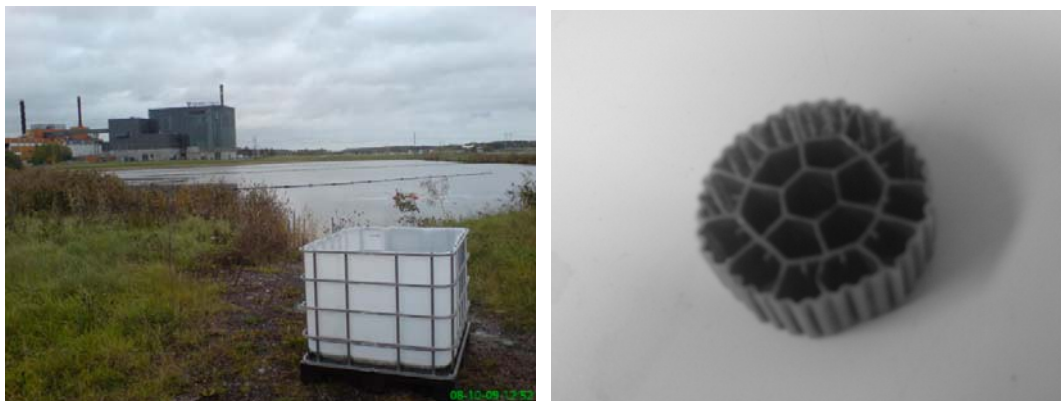
Figur 9. Till vänster, Cipaxbehållare för förvaring av bärarmaterial, uppställd bredvid den östra lakvattendammen vid Gärstad avfallsanläggning hösten 2008. Till höger, AnoxKaldnes K3 bärare som användes till försöken.
