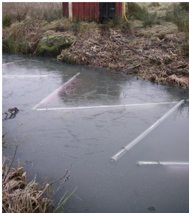
Bild 7. Ljusramper installerade i damm 1, Bergums vattenreningskärr. Privat bild.
