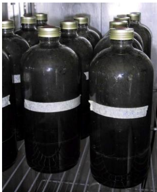
Figur 6 – Glasflaskor med substrat och ymp för metanpotentialförsök.
