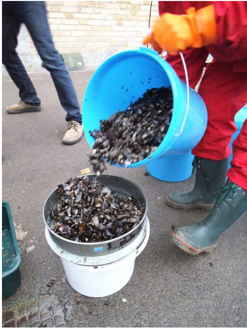
Figur 3 - Avskiljning av havsvatten från musslor innan behandling i tryckpress.
