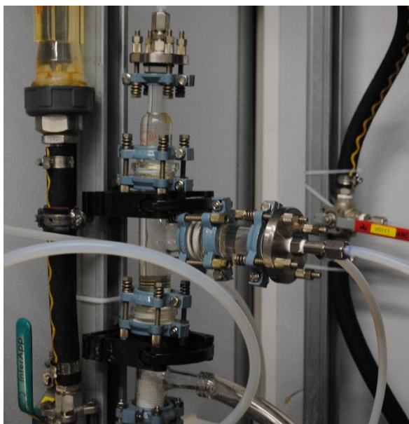
Figur 4.6 Partikelfälla där större partiklar så som grus avskiljs
