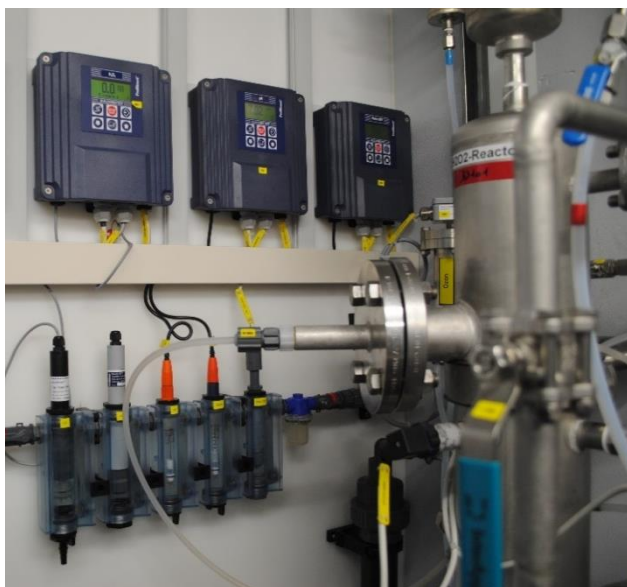
Figur 4.9 Online-loggning av pH, O 3 -koncentration, redoxpotential och temperatur
